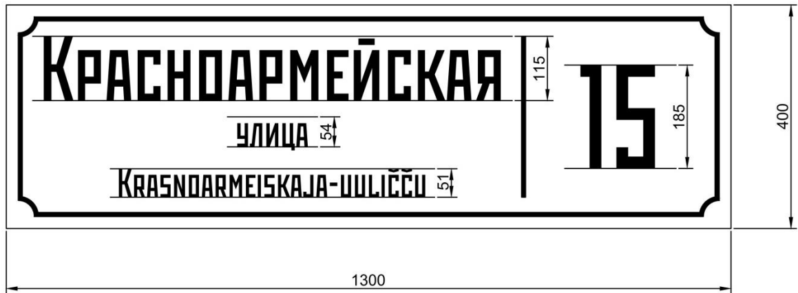
Рисунок 1. Стилизованное решение указателей с наименованиями улиц и номерами домов для многоквартирных жилых домов, зданий, сооружений.
